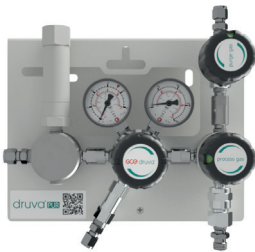
Typ MSLHOXSP0U Option P0 HD Spülventil (Prozessgasspülung im Eingang | keine Armatur im Ausgang) Zusatz U Rückschlagsventil im Eingang Sicherheitsventil im Ausgang
